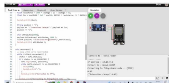
Gambar 5. Praktek Menghubungkan Simulator Wokwi dengan Thingsboard
