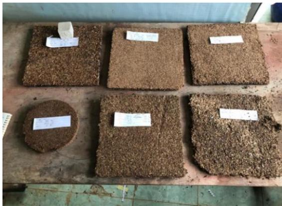
**Gambar 7.** Proses Pembuatan Papan partikel dengan Beberapa Komposisi Perekat
