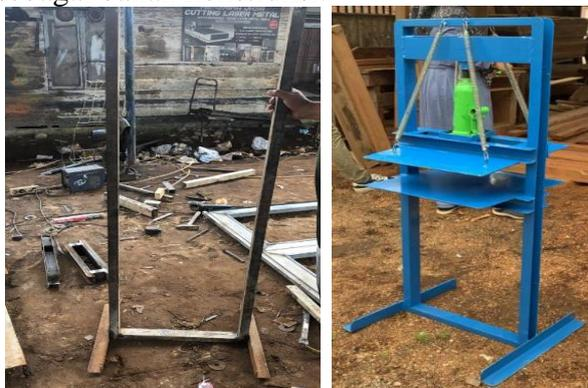
**Gambar 5.** Pembuatan Alat Pres sederhana; dan Alat Press Sederhana HYPRESSA
